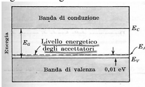
Figura 8 – Diagramma delle bande di energia di un semiconduttore di tipo p .
